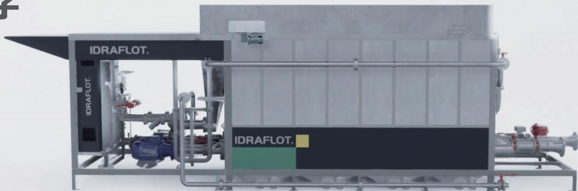
IDRAFLOT® SPF 是新一代溶气气浮设备，它使用了革命性的专利系统。该系统通过布置于混合区的喷头来产生“白水”。这种特殊的设备省去了传统的饱和罐，从而节省了占地和降低了成本。
